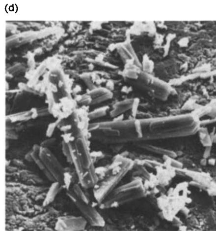
Fig. 2. Calcium gluceptate (anhydrous) (a) crystals; compacts stored at 25°C for: (b) 15 min, RH 0%; (c) 5 days, RH 0%; (d) 12 weeks, RH 43%. (a) 500×; (b) 4000×; (c) 1000×; (d) 800×.
